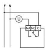
Collegamento con bruciatore, caldaia murale, impianto di condizionamento, valvola di zona con ritorno a molla.
